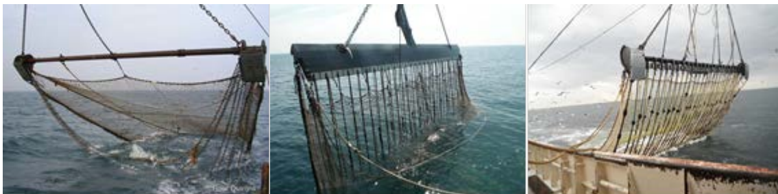
FIGUUR 2.1. VAN LINKS NAAR RECHTS: TRADITIONELE BOOMKOR, HFK PULSWING, DELMECO PULSKOR
